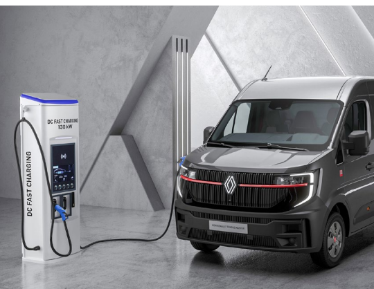
Las opciones de baterías de la Master Red Edition E-Tech están entre los 40 y 87 kW, que alimentan un motor de 105 Kw y un par máximo de 300 Nm.
