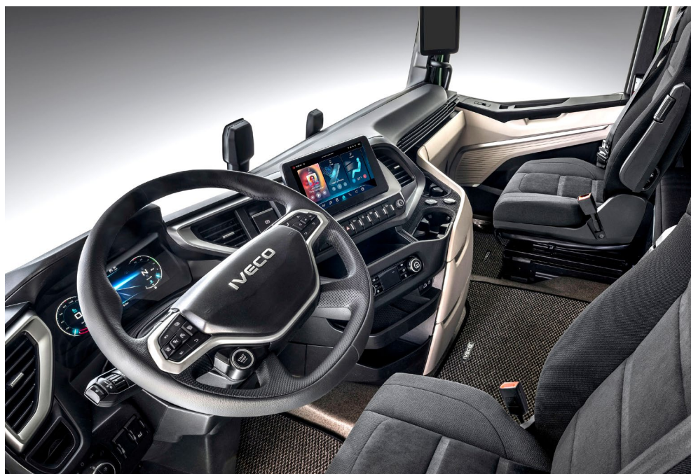
El interior del nuevo S-Way es completamente nuevo. Centrado en la figura del conductor, incluye un nuevo volante, pantalla de infoentretenimiento y funcionalidades de conectividad y un nuevo cockpit digital.
